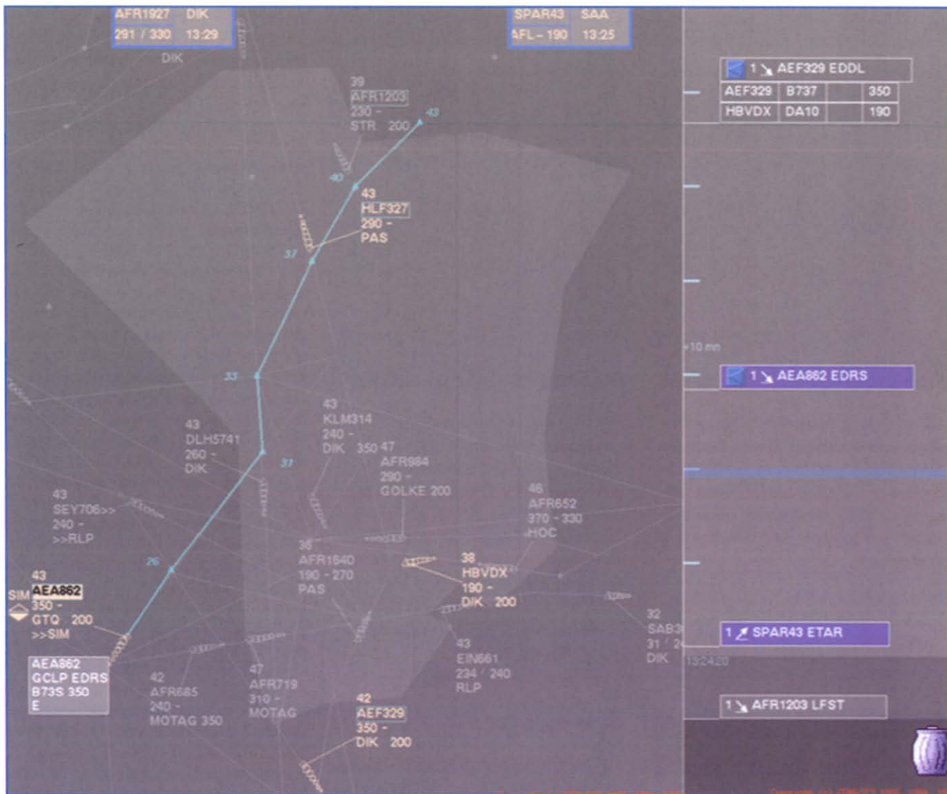
Photo 17. - L'intégration d'un vol se fait par la sélection d'une étiquette dans la fenêtre intégration. Tous les éléments relatifs à ce vol sont affichés dans l'interface : route graphique, macro-étiquette, filtrage de base, tableau des strips filtrés et particularisation en bleu des problèmes où le vol est significatif.
